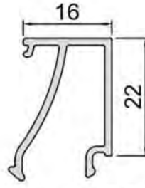
KOD-CODE CC-1160-13 TEORİK AĞIRLIK THEORETICAL WEIGHT 0,260 Kg/m
