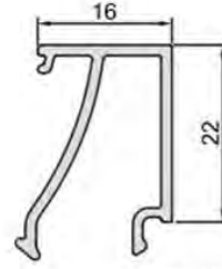
KOD-CODE CC-1160-13 TEORİK AĞIRLIK THEORETICAL WEIGHT 0,260 Kg/m
